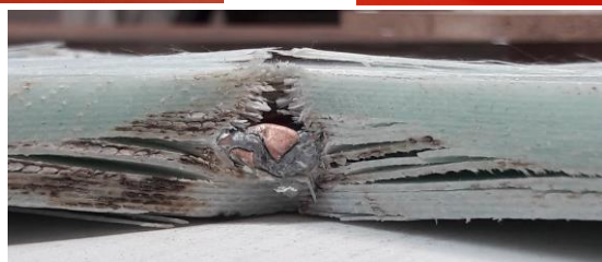
Fig. 2. Variante inițiale. 9 mm FMJ, 400 m/s
